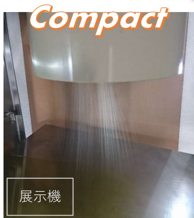
鍛造品 二次加工油・防錆油塗布
